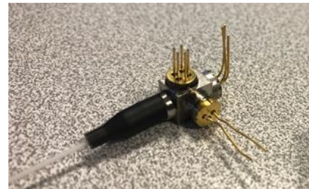
« TriOSA »: integrated TOSA + ROSA + red light emitter
